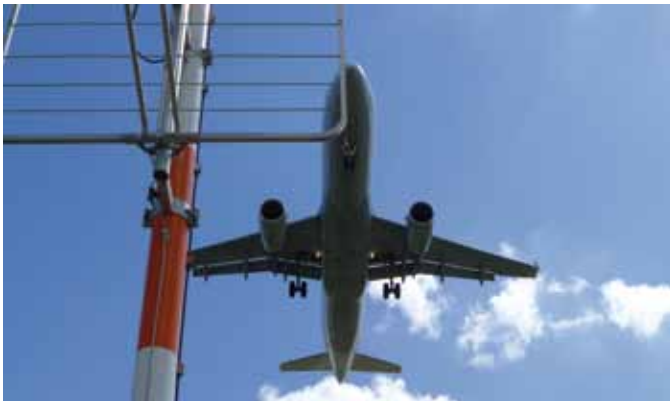
Ein Flugzeug landet über einer Antenne, mit der die korrekte Funktion des Landekurs senders überwacht wird
